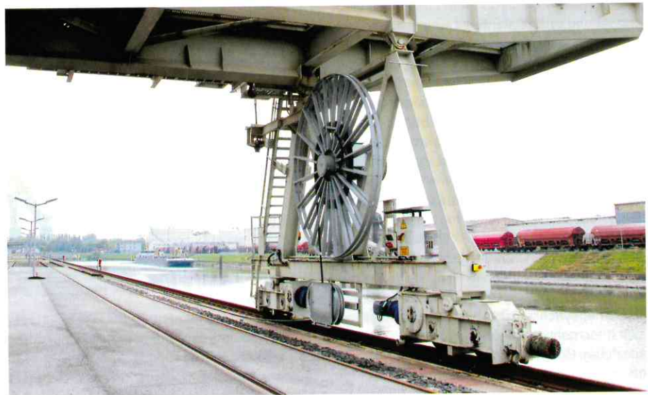
In einer Hafenkran-Anwendung wurde die neue spiralig wickelnde Leitungstrommel in der Mitte der Verfahrstrecke montiert. Mit einer Leitungslänge von 300 Metern deckt sie praktisch die gesamte Verfahrstrecke des Krans ab.
