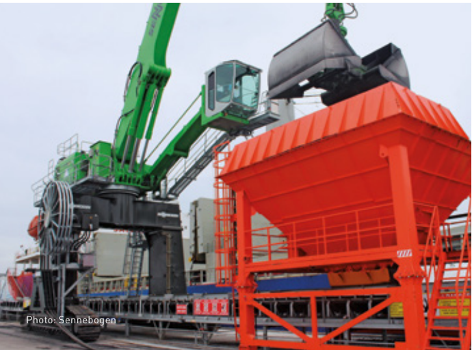
Zylindrisch wickelnde Leitungstrommel mit Träger-Konsole und Spulvorrichtung auf einem Raupenunterwagen. Geeignet für geringe Einbauhöhen und längere Verfahrswege. Schleifringkörper in der Kransäule.
