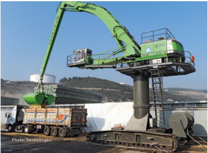
Spiralig wickelnde Leitungstrommel auf einem Raupenunterwagen. Geeignet für höhere Fahrgeschwindigkeiten und ausreichend Einbauraum nach oben. Energieübertragung von der Leitungstrommel über den Schleifringkörper innerhalb der Kransäule bis zum Motor (M).
